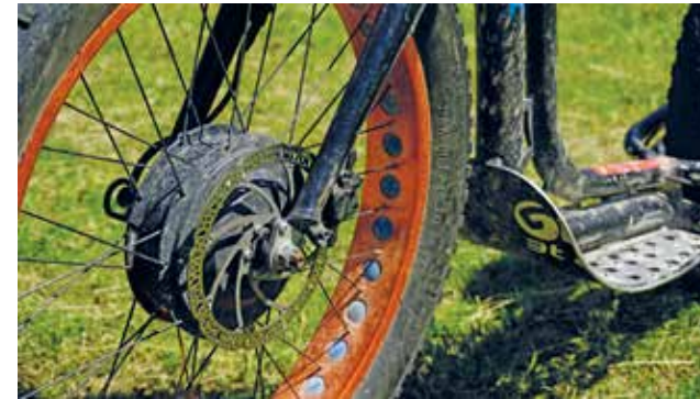
2X2 - La roue avant est motrice, indispensable en off-road dans les montées, nous l'avons vite constaté en action.
