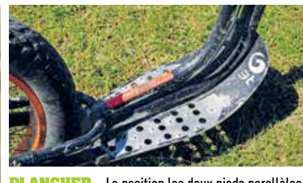
PLANCHER - La position des deux pieds parallèles est proche de celle de nos trials, en tout cas, ce n'est pas celle des trottinettes de ville.
