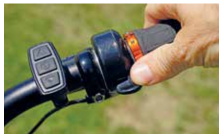
GÂCHETTE - Pas d'accélérateur comme sur une moto, mais une gâchette au pouce comme sur un quad.
