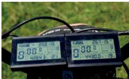
DOUBLE - Non, vous ne voyez pas double ! Deux moteurs, donc deux compteurs au guidon.
